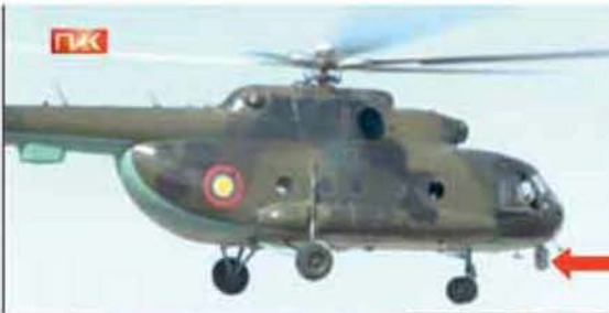
Նկ. 3. A-01 («ԱՍՏՐՈՍԱՓՍ») ՄՊԸ, Հայաստան) փորձարարական նմուշից տեղանքի պատկերի ստացումը
