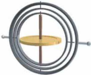
Նկ. 6. Կարդանային կախոցի շրջանակների ծալման երևույթը
