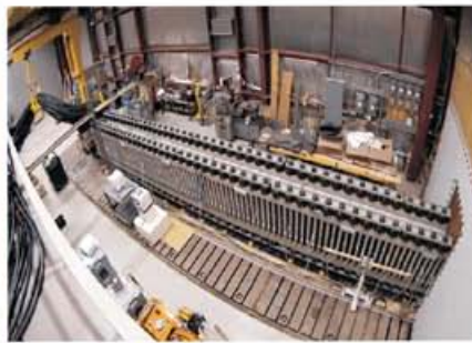
Նկ. 9. ԱՄՆ-ի «Naval Surface Warfare Center» կենտրոնի կողմից 2008 թ. հունվարի 31-ին փորձարկած ռազմանավային բազավորման ռելսային թնդանոթի կայանքի և «լցամասի» լուսանկարները
