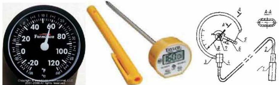
Նկ. 2. Երկմետաղական (ա, բ) և ճնշաչափային (գ) ջերմաչափերի կառուցվածքները
